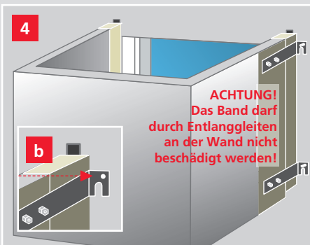
4 Setzen und Fixieren des Lichtschachts auf Höhe. Sicherstellen der Auftriebssicherung durch Verdübeln an der Kellerwand (Nutzung des Rundlochs siehe b)
