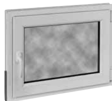
Kipp- und Dreh-Kippfenster mit Isolierglas 24 mm, weiß U_w=1,3 ( U_g=1,1 W/m 2 K) oder mit Isolierglas 36 mm, weiß U_w=1,0 ( U_g=0,7 W/m 2 K)
