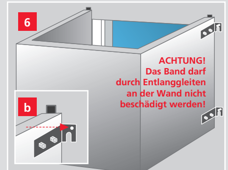
6 Setzen und Fixieren des Lichtschachts auf Höhe. Sicherstellen der Auftriebssicherung durch Verdübeln an der Kellerwand (Nutzung des Rundlochs siehe b).
