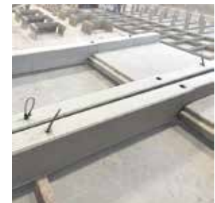
Auskragendes Podest für Anschluss ans Gebäude
