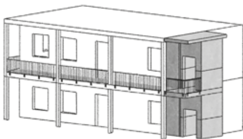
Aufzugschacht mit Vorraum vor dem Gebäude
